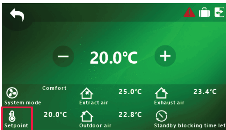
Afb. 5.6.1.4 Schermweergave ST-SA-Control en SALDA AIR temperatuur instelpunt
